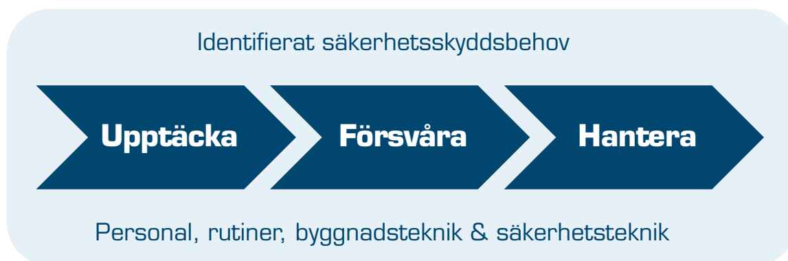
Figur 1: Fysisk säkerhet är ett system av säkerhetsskyddsåtgärder som tillsammans upptäcker, försvårar och hanterar obehörigt tillträde och skadlig inverkan.
